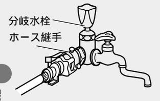
緊急止水弁付洗濯機用水栓で、一部当社継手と合わないものがありますので、確認してください。水栓は洗濯終了後、必ず閉じてください。給湯設備には取り付けないでください。
