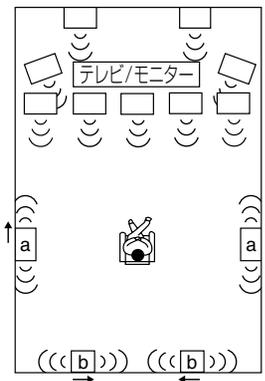
サラウンドスピーカーとサラウンドバックスピーカーの代わりにダイポール型スピーカーを使うことができます。ダイポール型スピーカーとは、前と後ろなど、2つの方向に同じ音を出す、双指向性スピーカーのことです。ダイポール型スピーカーでは位相\*1を合わせるため、多くのスピーカーには矢印表示が書いてあります。サラウンドスピーカー (図中a) は矢印 (↑) がテレビへ向かうように配置し、サラウンドバックスピーカー (図中b) は、お互いの矢印 (→) が向き合うように配置してください。
