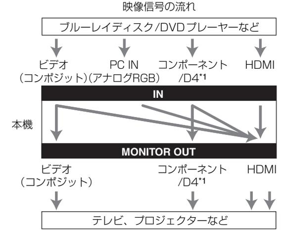
\*1 映像機器の映像出力から、モニターの映像入力までD端子で接続している場合のみ、アスペクト比などの制御信号を送れます。モニターによっては、制御信号を受け取れないことがあります。その場合は、モニター側で調整してください。
