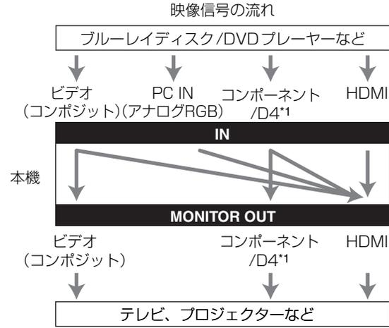
\*1 映像機器の映像出力から、モニターの映像入力までD端子で接続している場合のみ、アスペクト比などの制御信号を送れます。モニターによっては、制御信号を受け取れないことがあります。その場合は、モニター側で調整してください。
