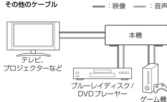
\*1 お使いのテレビがオーディオリターンチャンネル (ARC) 機能に対応していない場合は、本機をHDMIケーブルで接続すると同時に、光デジタルケーブルでも接続する必要があります。
