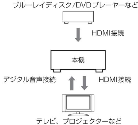
2. テレビからの音声出力を、光デジタルケーブルで本機の**OPTICAL IN 2**端子に接続する。
