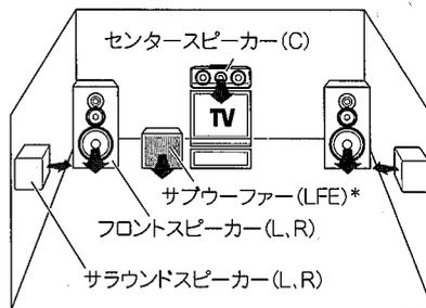
\* LFE = Low Frequency Effectsの略。このチャンネルは、サブウーファーに、指向性のない低周波数信号を送り、より深みのある低音の音場効果を再現します。このチャンネルが入力しているときは、ディスプレイに "LFE" 表示が点灯します。
