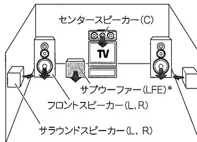
\* LFE = Low Frequency Effectsの略。このチャンネルは、サブウーファーに、指向性のない低周波数信号を送り、より深みのある低音の音場効果を再現します。ドルビーデジタル(AC-3)サラウンドトラックは、独立して低周波数チャンネルを持っていますが、サブウーファーを接続すると、他のサラウンドモードにおいても、低音の音質をよくすることができます。このチャンネルが入力しているときは、ディスプレイに「LFE」表示が点灯します。
