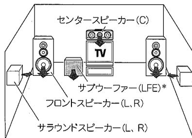
\* LFE = Low Frequency Effectsの略。このチャンネルは、サブウーファーに、指向性のない低周波数信号を送り、より深みのある低音の音場効果を再現します。このチャンネルが入力しているときは、ディスプレイに「LFE」表示が点灯します。
